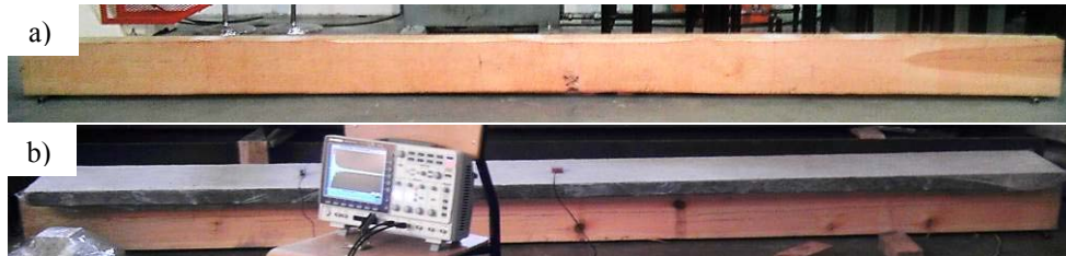
Rys. 1. Zdjęcia badanej belki drewnianej (a) i zespolonej (b).
