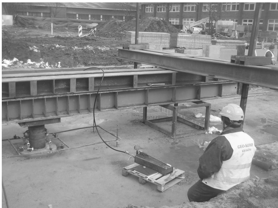
Rys. 2. Stanowisko do próbných obciążeń pala (fot. Ł. Janosz).
