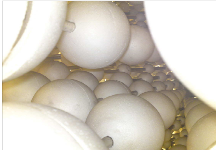
Bild 3. Einblick in die Kugel-Turbine (Erfinder Prof. Dr. B. Suthoff, Deutschland) Fig. 3. Insight into the ball-turbine (inventor Prof. Dr. B. Suthoff, Germany)
